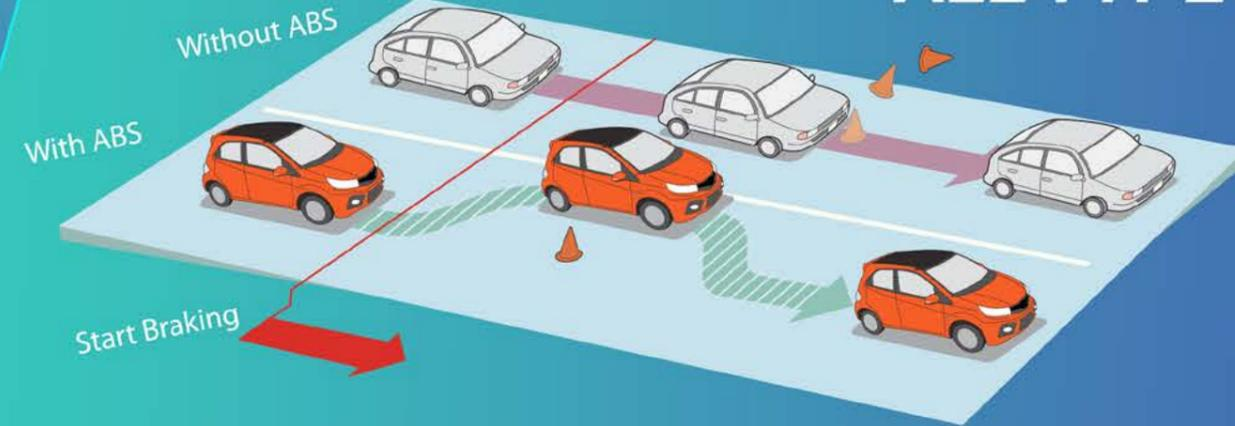
ABS (Anti-Lock Braking System) Mencegah penguncian roda pada saat pengereman mendadak.
